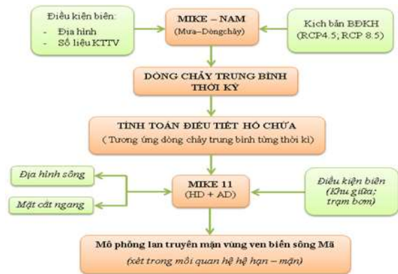
Hình 2. Sơ đồ áp dụng mô hình toán mô phỏng hạn - mặn vùng đồng bằng ven biển sông Mã
